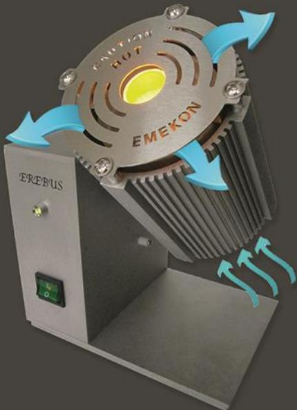
Mikrobiyoloji laboratuvarında çalışanlar kendilerini mikroorganizmalardan korumak zorundadırlar. Erebus, iki farklı steril işlemini aynı anda gerçekleştirir. Steril işlemi sırasında,  $20\text{ m}^3/\text{saat}$  ortam havasını IR ısıtıcı jeneratörü içinden dolaştırarak insineratör alanında da sterilizasyon sağlar.
